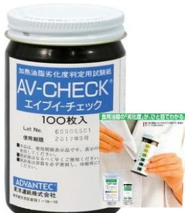
酸価測定の公定法である酸・アルカリ滴定法の原理に基づいてpH指示薬、塩基性物質を濾紙に含浸し、乾燥させた試験紙です。フライ油(加熱油脂)など、現場の品質管理に適しています。
